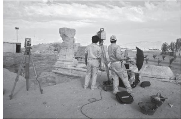
図6 129-b号墓を三次元計測する様子
