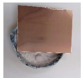
図4 銅板を被せた蒸着法
