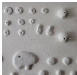
図1 石英粉を固めた本体
