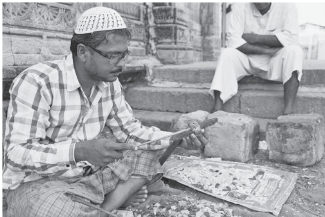
図1 カーンバートにおける現代石製装身具工房（筆者撮影） 左：鉄軸と水牛製ハンマーを用いた成形作業、右：弓錐を用いた伝統的な穿孔作業
