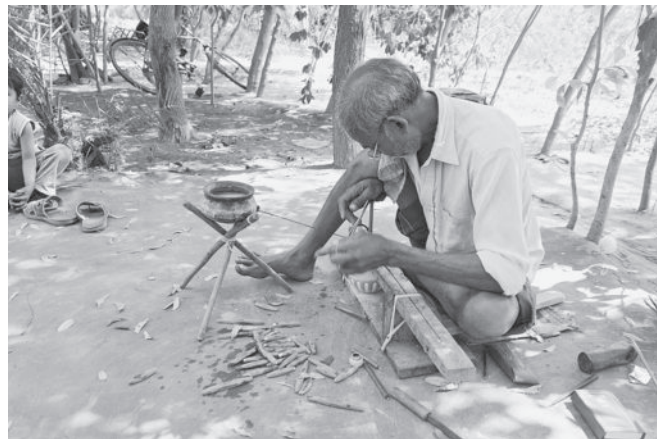
図1 カーンバートにおける現代石製装身具工房（筆者撮影） 左：鉄軸と水牛製ハンマーを用いた成形作業、右：弓錐を用いた伝統的な穿孔作業
