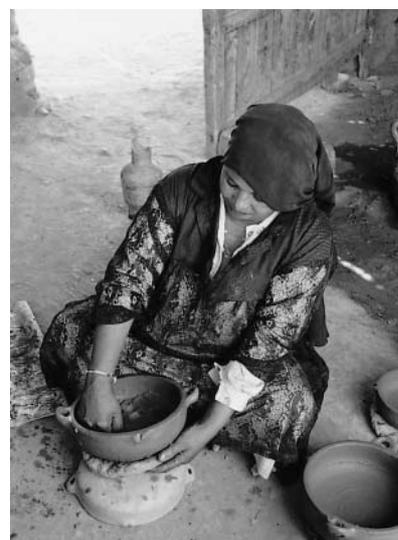
写真17 成形補助 (ヒガーザ)
